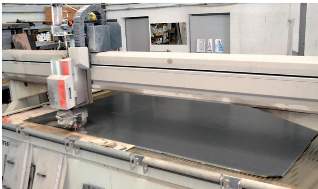
"Avec la technique de découpe au jet d'eau et notre Prismus 420, nous débitons deux fois plus vite dans la céramique et le Dekton® que dans le granit".
