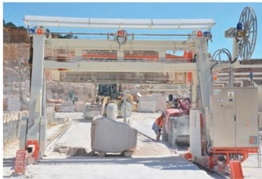
*Recoupe de blocs à la haveuse et équarrissage à la guillotine.*
